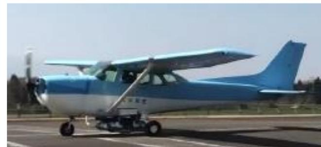
地上走行実験中の電動パワーユニットに換装されたセスナ機
