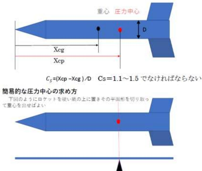
○安定性を最終的に確認するために重心を糸で吊るして行うスイングテストを実施し、ロケット先端が確実に前方(風上側)を向くことを審査員の前で示さなければならない。
